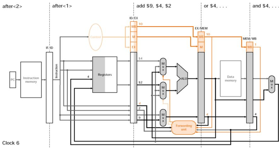
6. 아래 그림에서 Hazard detection unit의 각 input/output의 기능을 설명하고 그림에서 주어진 sequence의 instruction이 들어왔을 때 다음 cycle로 넘어갈 때 어떤 작업이 일어나는지 설명하시오. 마지막으로 다음다음 cycle에서 어떻게 internal forwarding이 되는지 설명하시오.
